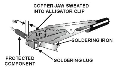
Figure 2-37.—Heat shunt.
